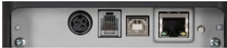
Ambos modelos tienen un interfaz USB y conexión a caja registradora. Solo tiene que escoger entre interfaz RS232 serie o Ethernet LAN (en la imagen).
